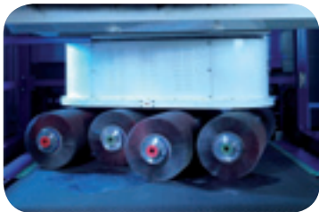
Rotationseinheit mit 8 gegenläufigen Bürsten
