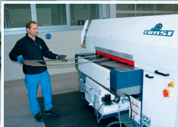
Eine für alles: Die Entgratmaschine EM 5N II /L +2 von Ernst bei Trumpf in Pasching/Österreich
