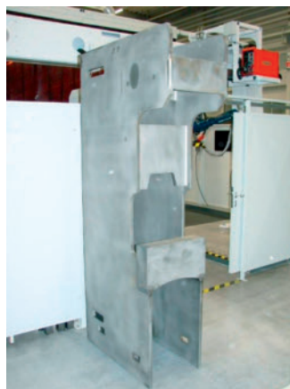
Basis für den Renner: Gestell einer Abkantpresse TruBend 7000, laut Trumpf ein absoluter Verkaufshit
