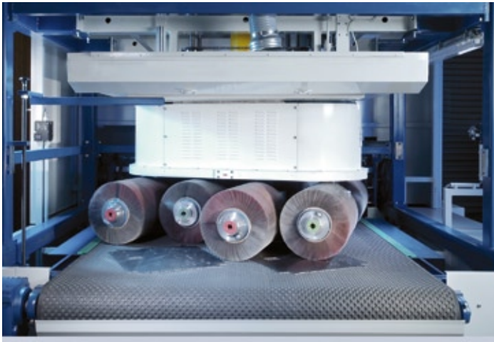
Die Rotationseinheit mit acht Bürstwalzen ermöglicht perfekte Verrundungsergebnisse auch deutlich über 2 m/min Vorschub.
