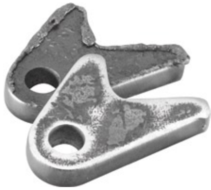
Selbst sehr stark gratbehaftete Plasma- oder Autogen-Teile lassen sich perfekt in einem Durchgang entgraten.
