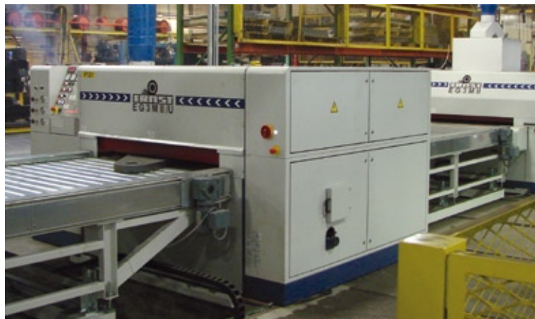
Durch den Aufbau einer Schleifstraße, die aus einer oben- und einer unten-schleifenden Maschine besteht, erhält der Anwender eine Anlage, auf der sich längere Teile in einem Durchgang beidseitig entgraten und entschärfen lassen.
