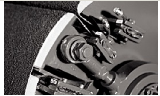
Durch den Einsatz von Bogenware sind die Beschaffungskosten für Schleifmittel etwa 50 Prozent niedriger als bei Endlosbändern. Durch ein spezielles Spannsegment kann ein Schleifmittelwechsel in drei Minuten durchgeführt werden.
